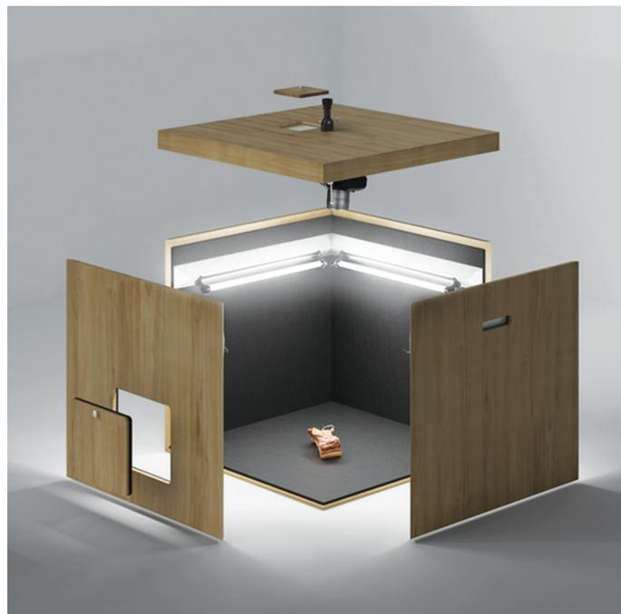
Рис. 1. Система компьютерного зрения (получения изображений) [10]
